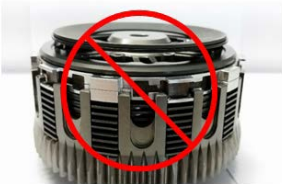
Positionnement incorrect : la coupelle de ressort est montée à l'envers.
