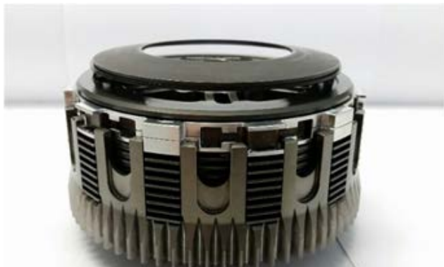
Richtig – Die Tellerfeder liegt flach am Schleifring an.
