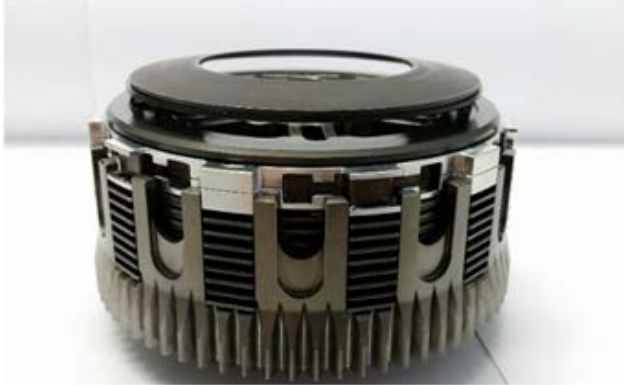
Positionnement correct : la coupelle de ressort repose à plat sur la bague de frottement.
