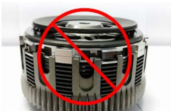
Falsch – Die Tellerfeder ist verkehrt herum eingebaut.
