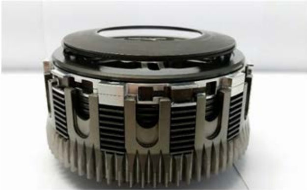
Correcto - la arandela elástica está completamente apoyada en el colector.
