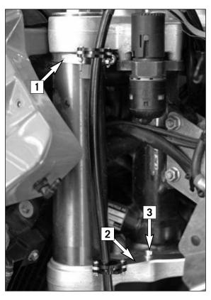
Montieren Sie mittels der Rohrschelle [1] die obere Führung (Lasche nach unten) und mit dem Halteblech [2] die untere Führung mit zwei Linsenkopfschrauben M6x12 [3] der Bremsleitung.
