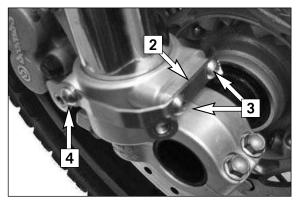
Montieren Sie die beiden Adapterringe mit je zwei Distanzplatten [2] je zwei Linsenkopfschrauben M6x16 [3] und eine Linsenkopfschraube M6x12 [4].
