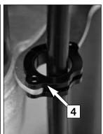
Die Kunststoffbremsleitungsführungen leicht aufbiegen und über die Bremsleitung schieben.
