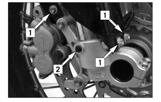
Schrauben sie den Original Kotflügel ab. Dieser wird von insgesamt sechs Schrauben [1] an den beiden Gabelfäusten gehalten. Jeweils ein weiteres Gewinde [2] wird für die spätere Befestigung der Gabelprotektoren benötigt und muss freigelegt werden.
