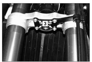
Des weiteren muss die Führung der verbleibenden originalen Bremsleitung durch entfernen der 4 Schrauben [3] an der unteren Gabelbrücke abmontiert werden.
