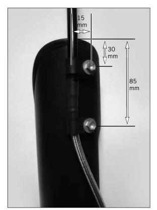
Bohren Sie für die Halterung am Gabelprotektor 2 Löcher (von der Mitte 15mm nach innen und von oberer Kante 30mm und 85mm nach unten) mit einem Durchmesser von 6mm. Verschrauben Sie die Klemmen der Stahlflexbremsleitung mit dem Gabelprotektor benutzen sie dafür die Sechskantbundschrauben M6x20 und die Selbstsichernde Muttern.
