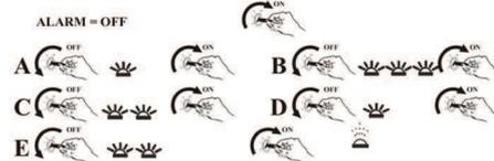
**B)** Dentro de los 3" volver a girar la llave a la posición OFF y esperar el parpadeo del LED para la segunda cifra; confirmar la cifra y continuar con los puntos C- D y E. Una vez que se ha confirmado la quinta cifra dejar la llave en la posición ON (+15); si el código introducido es exacto, la alarma emitirá cuatro sonidos de zumbador bi-tonales y el LED permanecerá apagado.
