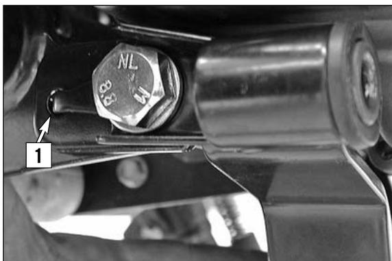
Smontare la vite posteriore del supporto del motore e il supporto del collettore. Posizionare la staffa posteriore e il supporto del collettore (fare attenzione che la piegatura a gomito del supporto del collettore **(1)** ingrani nella cavità della staffa posteriore.
