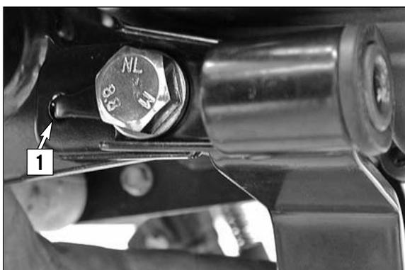
Hinteren Motorhalterungsschraube und Halter für Krümmer demontieren.
