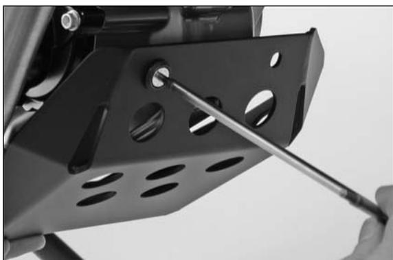
Montar el colector y la sonda lambda. Atornillar el protector del motor a los estribos de sujeción, utilizando los tornillos de cabeza avellanada M6x20 y las arandelas perfiladas M6. Alinear el protector del motor de manera que quede montado sin tensiones mecánicas. Apretar los tornillos M6 con adhesivo Loctite 243 y un par de apriete de 10 Nm, y los tornillos M10 con adhesivo Loctite 243 y un par de apriete de 45 Nm. Montar el depósito y las chapas de protección térmica de los silenciadores.
