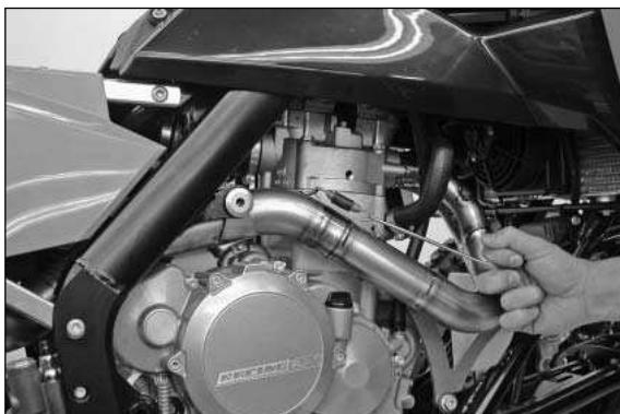
Poner juntos la parte de empalme del codo Akrapovic y la parte de conexión del codo. Montar los tubos del codo Akrapovic, alinearlos y fijarlos juntos con los muelles del escape suministrados en la brida del escape.
