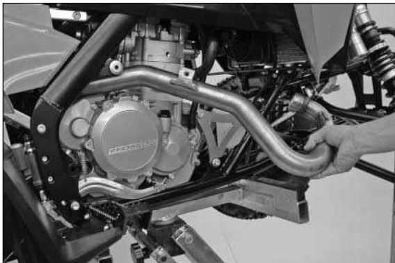
Soltar el tornillo de fijación del codo de serie y retirar el muelle del escape en la brida del escape.
