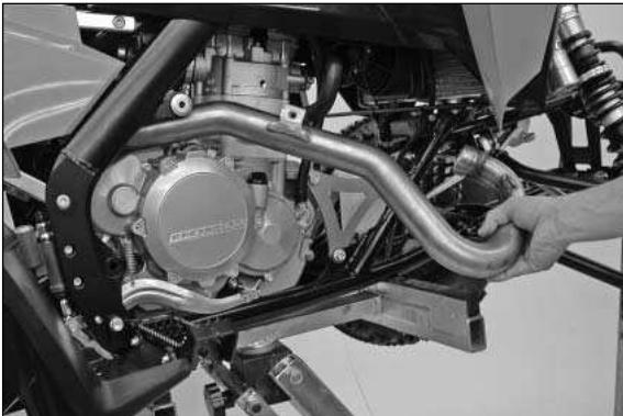
Befestigungsschraube des Serienkrümmers lösen und die Auspufffeder beim Auspuffflansch entfernen.
