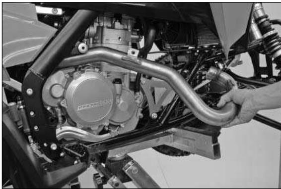
Retirer la vis de fixation du tube de série et décrocher le ressort en sortie de culasse.
