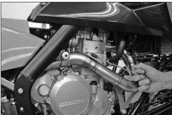
Akrapovic Krümmeranschlussteil und Krümmerverbindungsteil zusammenstecken. Akrapovic Krümmerrohre montieren, einrichten und mit den mitgelieferten Auspufffedern miteinander und am Auspuffflansch befestigen.
