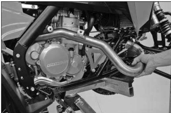
Svitare la vite di fermo del collettore di serie e rimuovere la molla del silenziatore sulla flangia.
