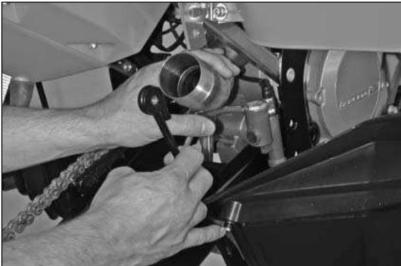
Befestigung Fersenschutz lösen.
