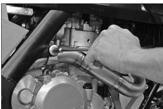
Serrare la vite M8x30 solo quando i tubi del collettore sono ben posizionati e senza tensione tra i componenti.
