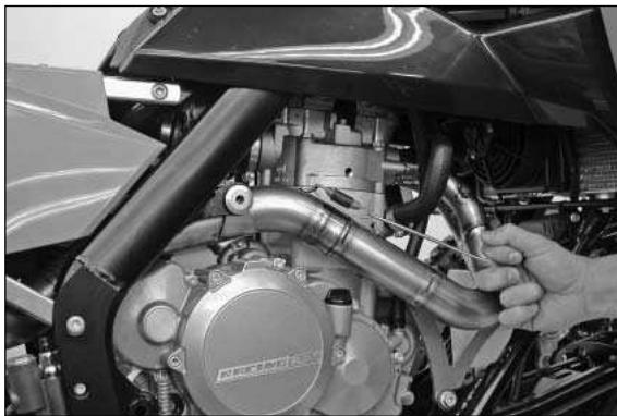
Enfiler l'un dans l'autre le tube de sortie et le tube de raccordement. Présenter l'ensemble, le mettre en place et le fixer au moyen des ressorts livrés dans le kit, cela au niveau du raccordement des deux tubes et au niveau de la culasse.
