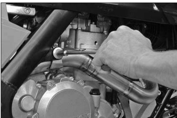
Schraube M8x30 erst festziehen, wenn die Krümmerrohre spannungsfrei montiert sind.
