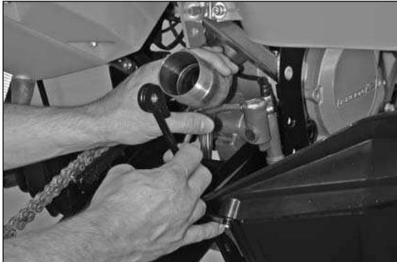
Svitare il dispositivo di fissaggio del paratacco.
