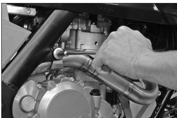
Apretar el tornillo M8x30 solamente cuando los tubos de codo estén montados sin tensión alguna.
