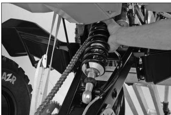
Desmontar el amortiguador.
