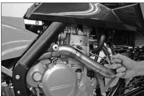
Montare insieme il tubo di raccordo intermedio e il tubo di raccordo Akrapovic.
